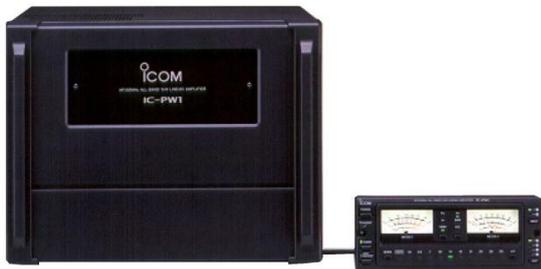
Всережимный линейный усилитель мощностью 1 кВт включает автоматический блок настройки антенны. Имеет автоматическую настройку и автоматический выбор диапазона. возможна работа полным дуплексом (QSK). Модуль усилителя, блок питания и устройство дистанционного управления разделены. Для соединения требуется дополнительный кабель адаптера OPC-599.
