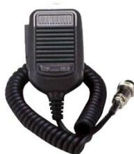
Ручной микрофон, оснащенный кнопками [UP]/[DOWN]. То же, что и в комплекте с трансивером.
